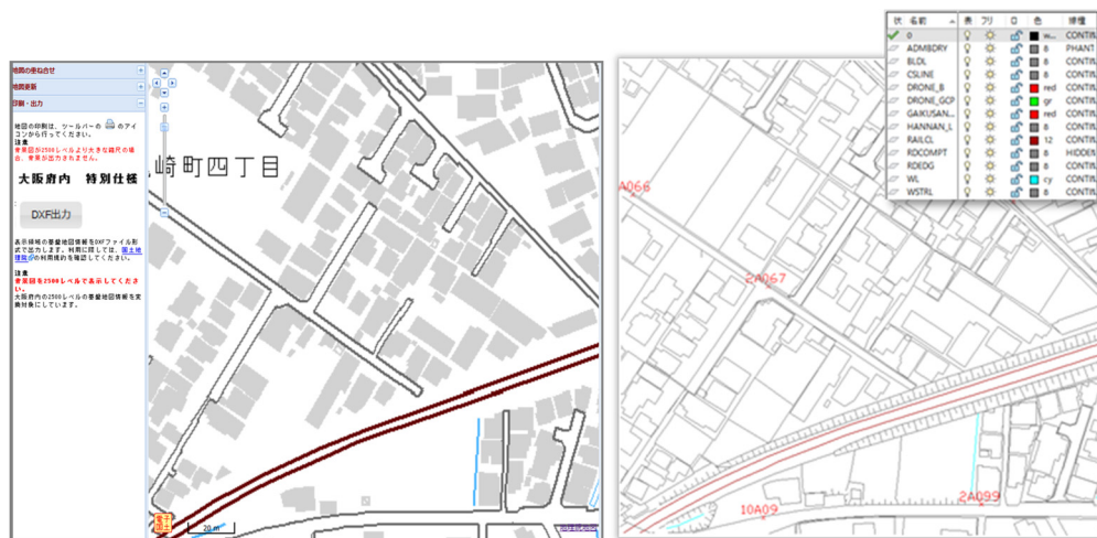
図1 既存の DXF 出力ツールの画面
